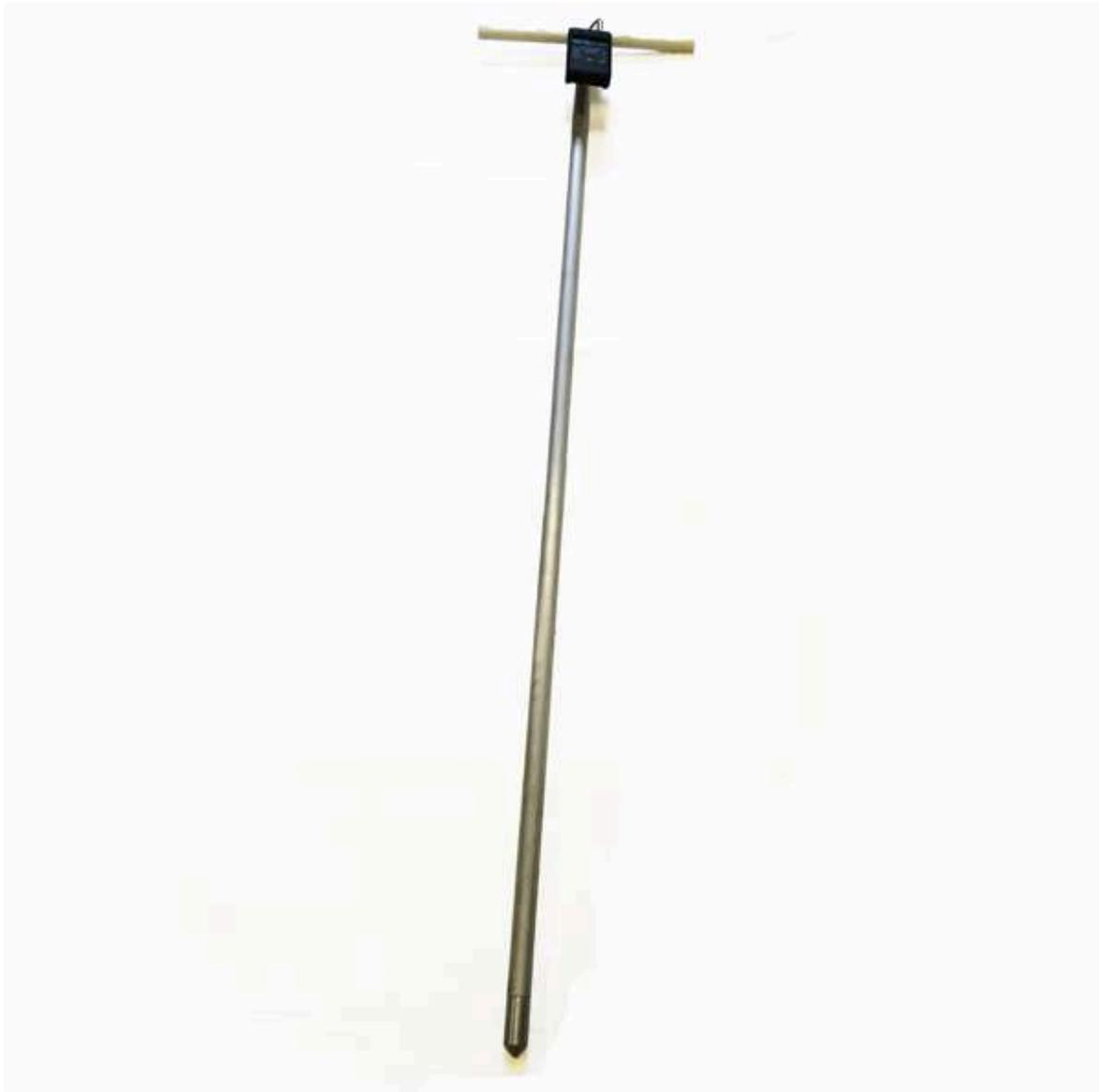
**Термоштанга Laboratoroff с термогигрометром
